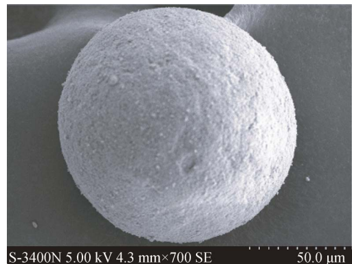
图2 单个纳米 Fe-Al/Cr 3 C 2 造粒后的形貌
